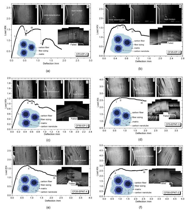
Fig. 5. Delaminating process of specimen (a) CF0-EP, (b) CF25-EP, (c) CF50-EP, (d) CF0-EPNT, (e) CF25-EPNT and (f) CF50-EPNT.
