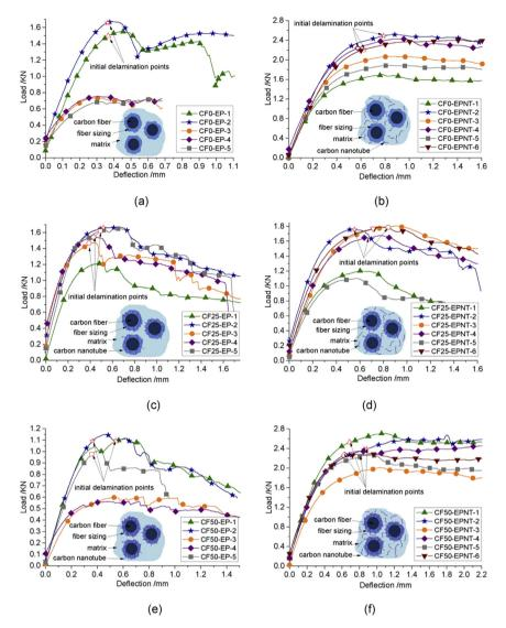
Fig. 3. Load-deflection curve of specimen (a) CF0-EP, (b) CF0-EPNT, (c) CF25-EP, (d) CF25-EPNT, (e) CF50-EP, (f) CF50-EPNT.
